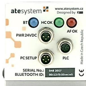
Obr. 5 Rozmístění LED signalizace a konektorů na zadní straně
