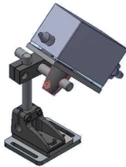
Obr. 8 Doporučená konstrukce k uchycení detekční sondy
